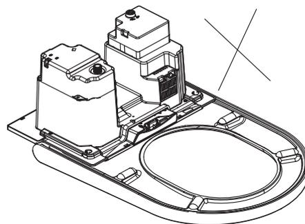
1. Houd de plug vast met de tang, draai hem naar "Open" en trek hem eruit. De tank loopt leeg.
